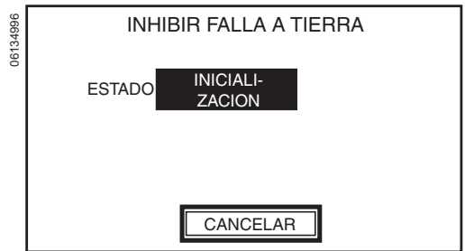
Figura 49: Pantalla de activación “Inhibir falla a tierra”
